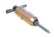
防音ブレーカーカバー併用でさらに減音
