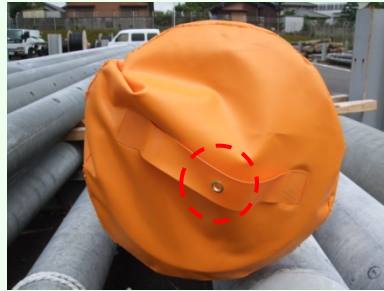
⑤長尺物の運搬時に必要な赤旗を、取付ける穴。
