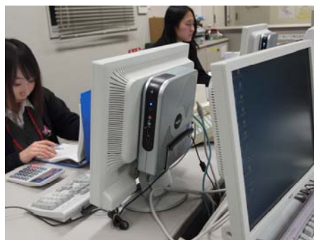
ディスプレイ裏面に設置されたコンパクトなシンククライアント端末
